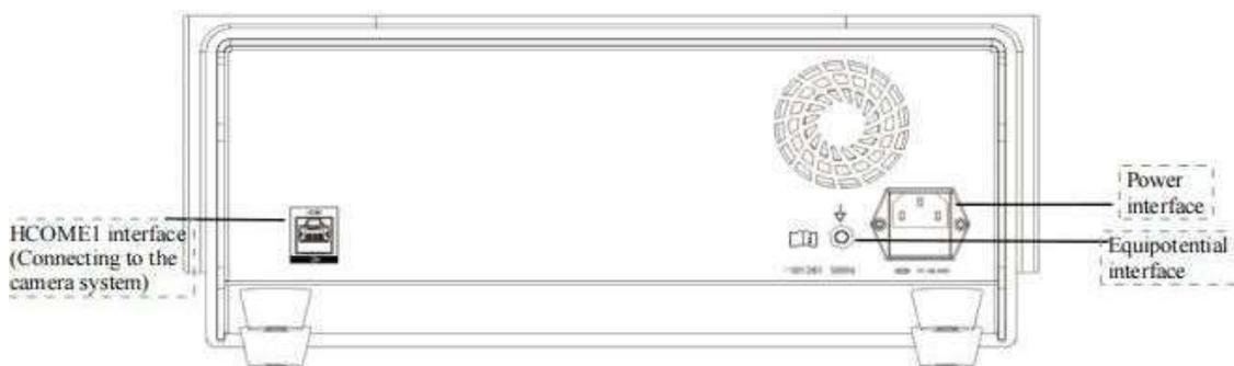
**Figura 2-4** Diagrama esquemático do painel traseiro da unidade principal da fonte de luz fluorescente
