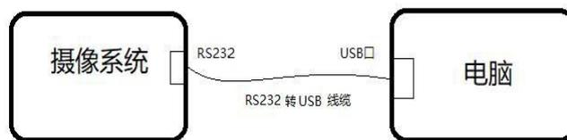
Figura 2-20: Diagrama esquemático da conexão entre o computador e o dispositivo.
