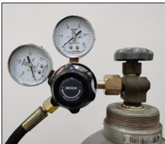
Diagrama de conexão do cilindro de gás, válvula de descompressão e tubo de alta pressão
