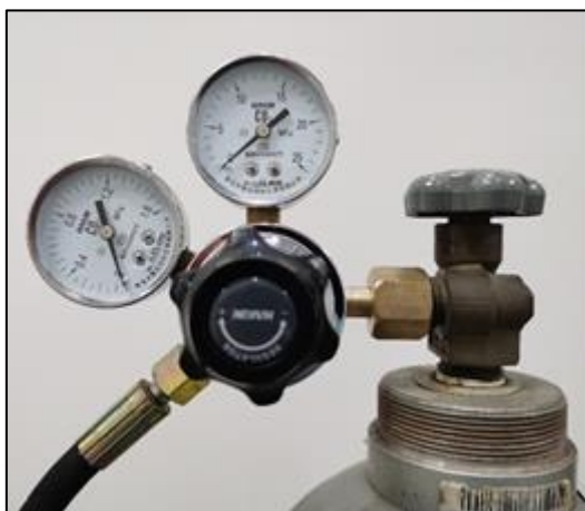
Diagrama de conexão do cilindro de gás, válvula de decompressão e tubo de alta pressão
