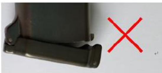
Figura 11: Fechamento incorreto da cobertura do dispositivo.
